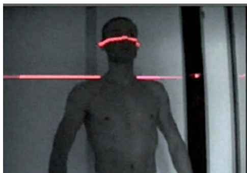
FIGURA 2. Tècniques de mesura 3D del cos humà mitjançant l'escaneig seqüencial per línia làser (Vitronic GmbH) (a), i projecció de franges en tot el camp (b).
